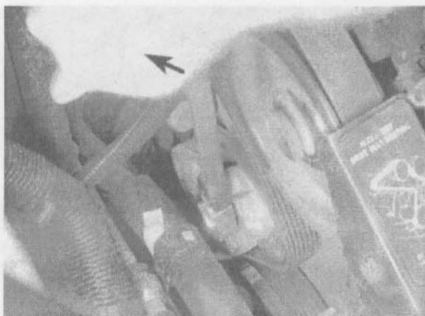
21.5. Вставьте специальный стержень в натяжитель и поверните его против часовой стрелки, чтобы снять или установить ремень
