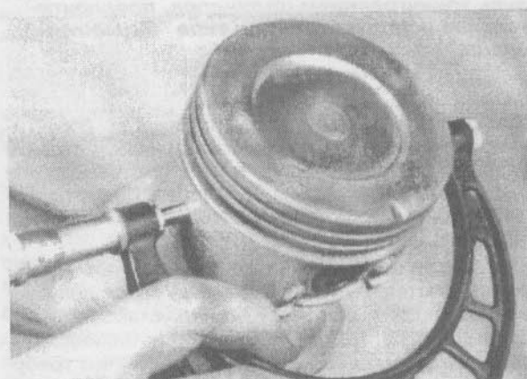
18.11. Измерьте диаметр поршня под углом 90° к поршневому пальцу, а также на одной линии с пальцем
