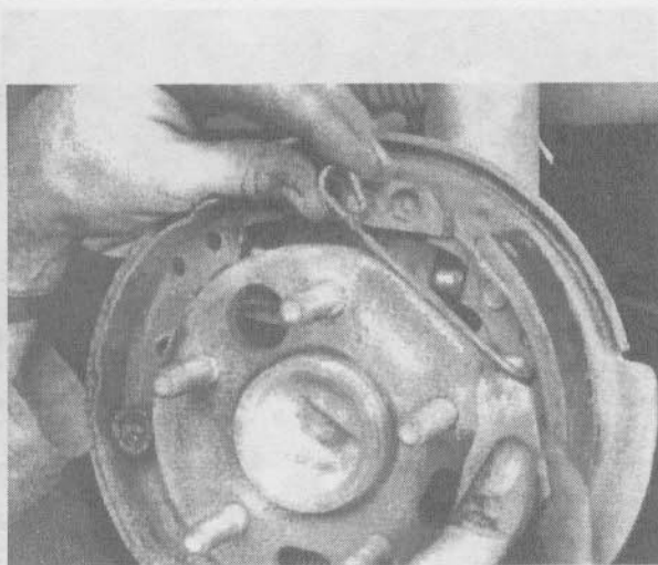
5.4я. Установите ограничитель и рычаг на вторичную тормозную колодку (автомобили выпуска 1990 и 1991 гг.)
