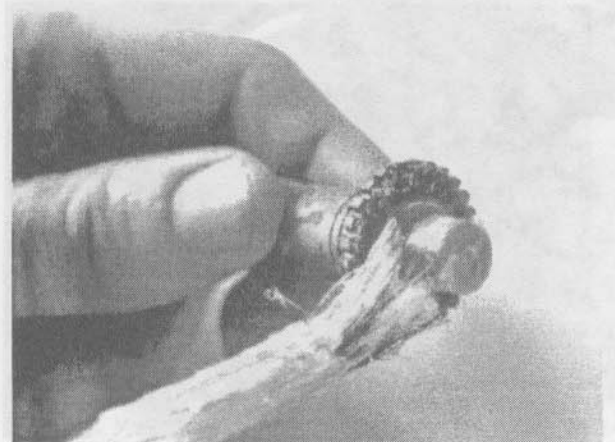
5.4ф. Смажьте регулировочный винт белой смазкой на литиевой основе перед тем, как его вворачивать (все модели)
