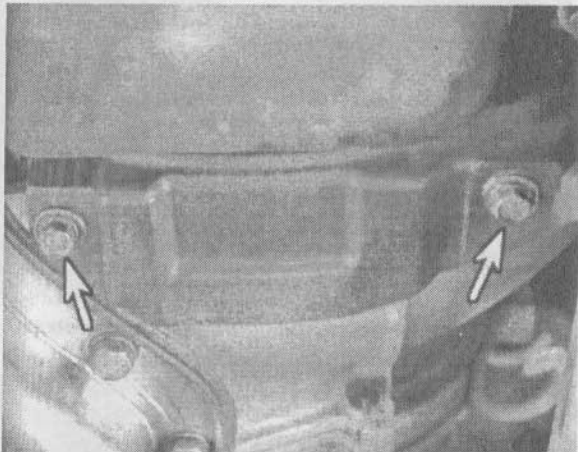
5.13а. Для снятия крышки маховика отверните эти два болта снизу,...
