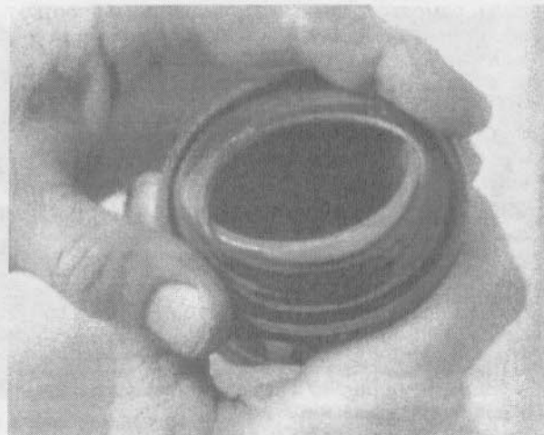
3.16. Вставьте новый пыльник в канавки поршня так, чтобы сгибы были направлены к открытому концу поршня
