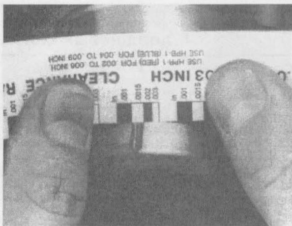
23.15. Измерьте толщину расплюснутой калибровочной проволоки для определения зазора подшипников шатунов (не перепутайте шкалу - имеется как дюймовая, так и метрическая)
