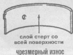
20.1. Типичные признаки разрушения подшипников
