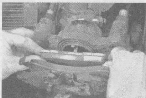
2.6л. Разместите колодки и защелкните внутреннюю колодку на ее место в поршне
