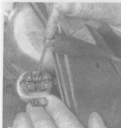
3.23. Подайте напряжение от аккумуляторной батареи на серый провод на клемме реле топливного насоса и прислушайтесь, заработал ли топливный насос
