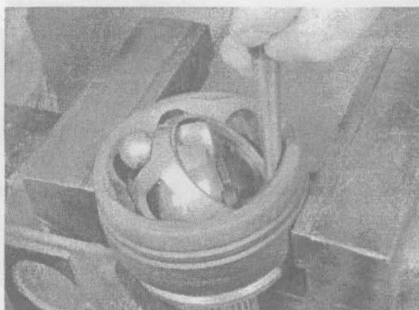
3.4в. Надавите на внешнюю дорожку качения так, чтобы можно было снять шарики; если наклонить ее будет трудно, осторожно постучите по сепаратору и внутренней дорожке качения пробойником или молотком
