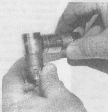
10.9в. Основание толкателя должно быть слегка выпуклым; для проверки наличия выпуклости можно использовать другой толкатель, приложив его боковой поверхностью к основанию первого. Если основание проверяемого толкателя плоское, это свидетельствует о том, что он сильно изношен и требует замены
