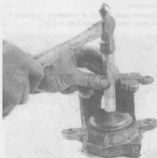
3.18. Пользуясь специальным инструментом для установки прокладок, осадите пыльник в канавке суппорта. Если такой инструмент у вас отсутствует, осторожно постучите по окружности чехла оправкой, пока пыльник не сядет на свое место
