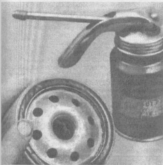
12.18. Смажьте прокладку масляного фильтра чистым моторным маслом перед тем, как установить фильтр на двигатель
