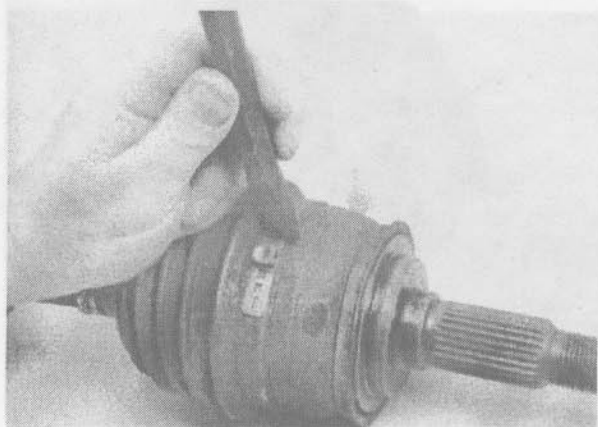
3.4а. Обрубите полоску крепления защитного чехла на валу, затем сместите защитный чехол к центру полуоси
