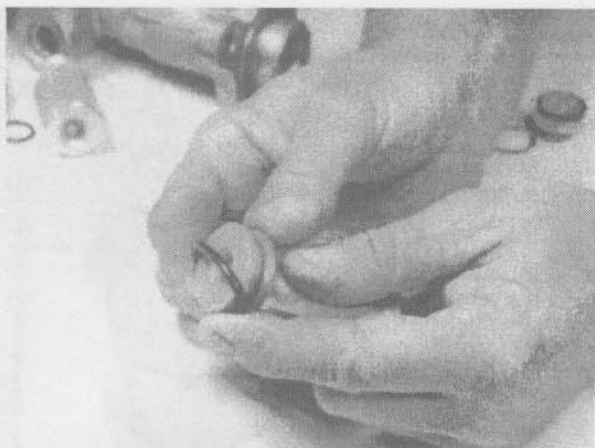
7.19е. Смажьте уплотнительное кольцо чистой тормозной жидкостью, затем наденьте его на поршень
