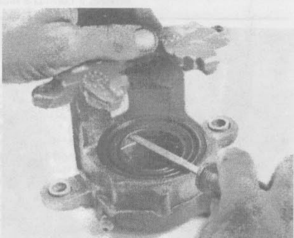
3.10. Осторожно извлеките пыльник из кожуха, стараясь не поцарапать поверхность цилиндра
