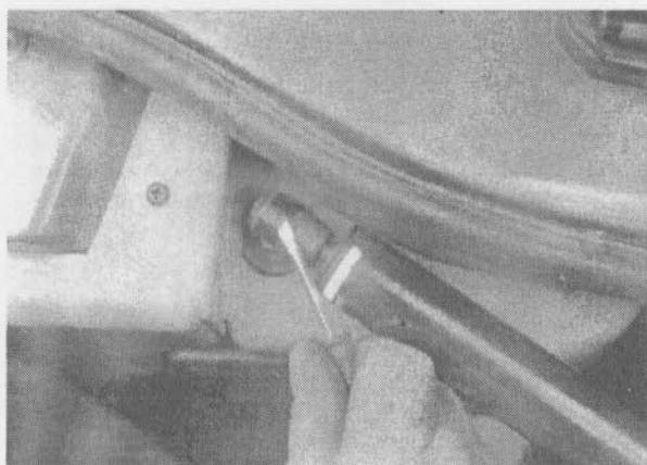
17.1а. Откройте заднюю дверь вверх до отказа и отверните крепление газовой пружины
