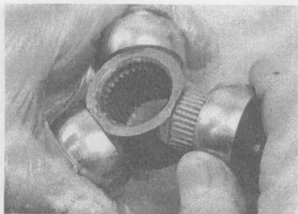
3.3к. Нанесите слой смазки шарниров равных угловых скоростей на поверхность внутреннего ролика, чтобы удерживать игольчатые подшипники на месте, и оденьте на них ролик
