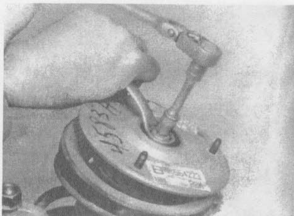
3.5. После сжатия пружины отверните гайку штока амортизатора
