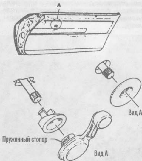
11.2а. Чтобы снять внутреннюю панель передней двери, отсоедините пружинный стопор (зажим) ручки и извлеките узел из дверцы
