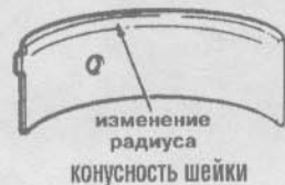
20.1. Типичные признаки разрушения подшипников
