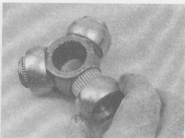
3.3з. Очистите от старой смазки кожух и узел крестовины, затем снимите ролики по одному
