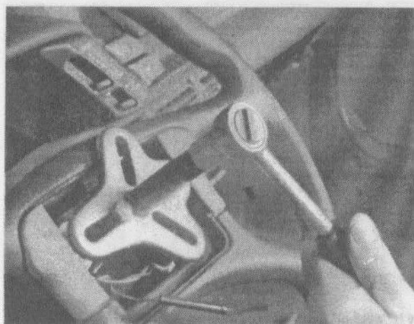
21.6. Для отделения рулевого колеса от вала воспользуйтесь съемником рулевого колеса - не пытайтесь удалять колесо с помощью молотка
