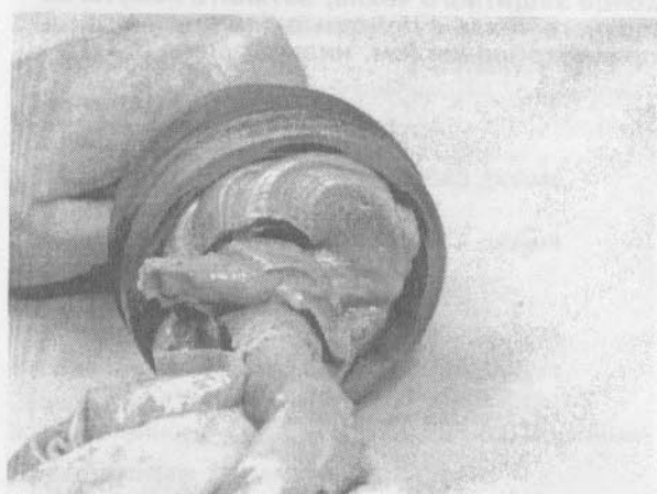
3.4о. Заложите через внутреннее шлицевое отверстие смазку в шарнир равных угловых скоростей, затем...
