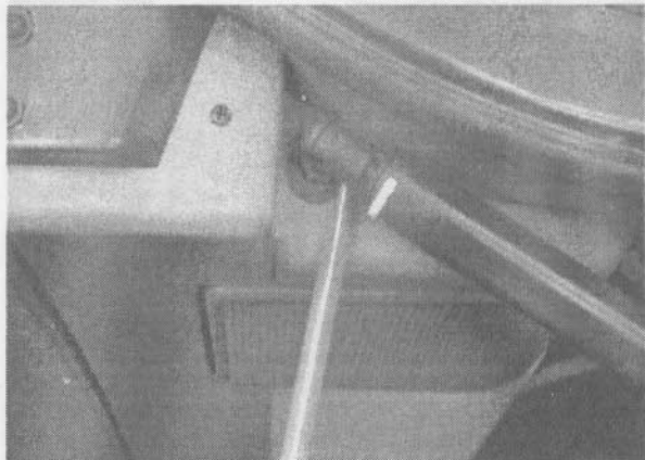
17.1б. Подоприйте заднюю дверь и отожмите нижний конец пружины, освободив его из шпильки с шаровым наконечником
