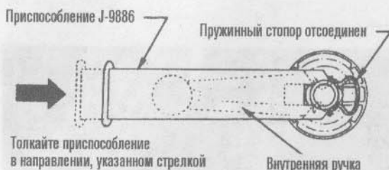
11.2б. Для отсоединения пружинного стопора можно использовать специальное приспособление, но подойдет и просто изогнутая проволока
