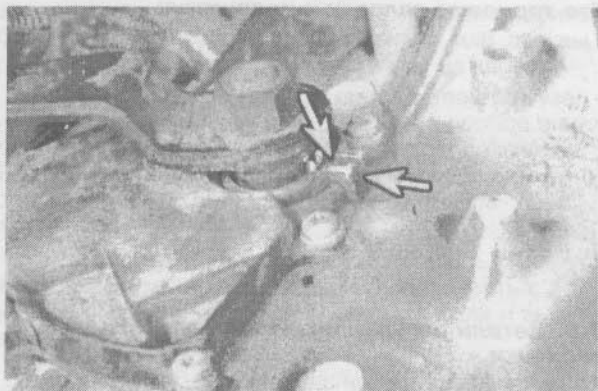
4.9. Внешняя метка должна совпадать с внутренней, расположенной на валу селектора
