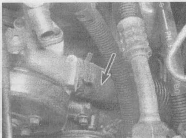
8.3в. Зажмите хомут шланга, сместите его назад на шланге и отделите нижний шланг радиатора от насоса системы охлаждения
