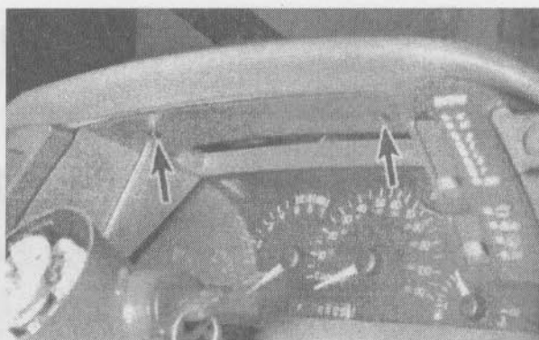
22.1г. Отверните два винта (указаны стрелками), которыми крепится верхняя панель к рамке
