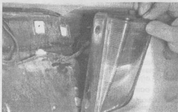
14.18. Отсоедините винты и корпус дублирующего фонаря
