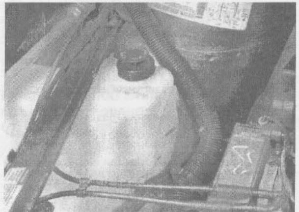
4.9. Расширительный бачок располагается на правой ("пассажирской") стороне моторного отсека. Охлаждающую жидкость можно доливать в бачок после снятия крышки
