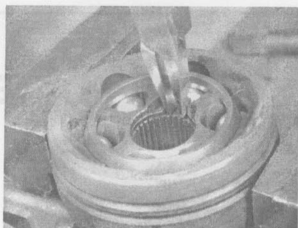
3.4н. ...осадите его кольцо в канавку с помощью специальных плоскогубцев для упорных колец
