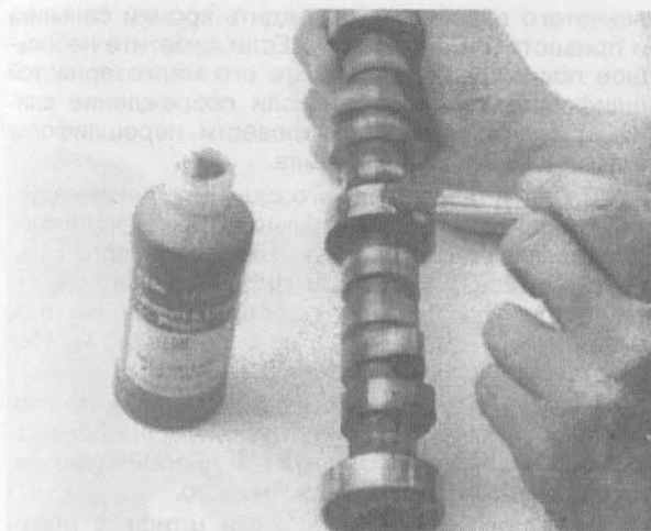
24.1. Обязательно нанесите смазку на шейки и кулачки распределительного вала перед его установкой
