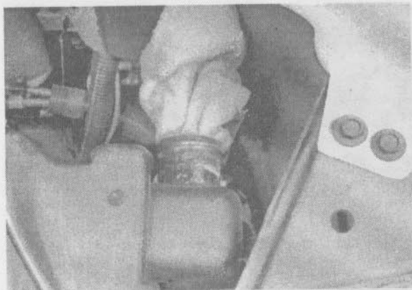
5.4ж. Заткните или закройте крышками трубопроводы и патрубки для предотвращения выливания охлаждающей или гидравлической жидкости при снятии радиатора
