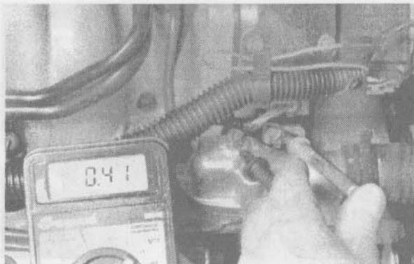
4.25б. На двигателе 3,8 л напряжение должно находиться в пределах 0,4-4,2 В. Подсоедините положительный вывод тестера к контакту "В", а отрицательный - к контакту "С" (замкнутому на "массу")
