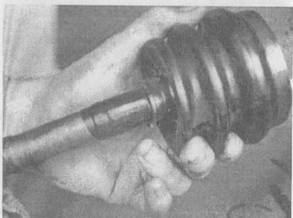
3.3л. Чтобы избежать повреждения защитного чехла, оберните шлицы полуоси лентой, затем оденьте защитный чехол на полуось
