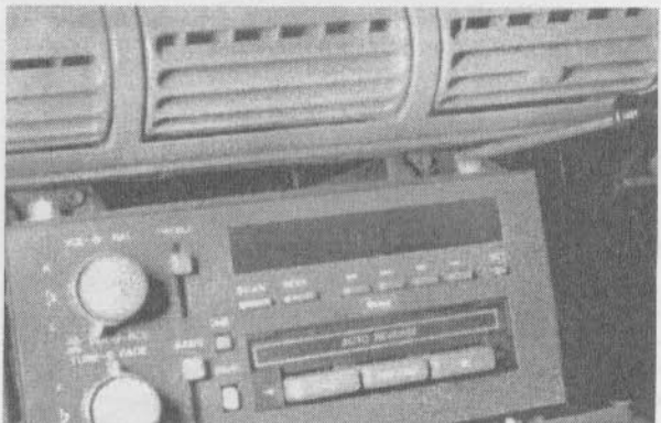
15.7а. Используйте отвертку Torx с шестигранной головкой для отворачивания двух винтов крепления верхней части магнитолы
