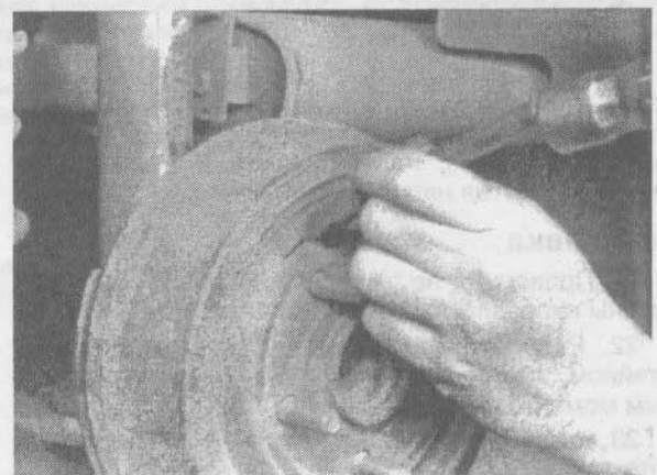
5.4а. Если тормозной барабан не удается снять, может оказаться необходимым удалить выступающий контур с помощью слесарного зубила и молотка (на некоторых автомобилях его приходится высверливать с помощью сверла диаметром 7/16 дюйма), затем поверните регулировочный винт так, чтобы отодвинуть тормозные колодки от барабана
