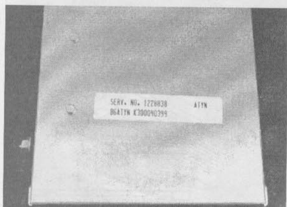
3.8а. Если вы заменяете ЕСМ, сравните сервисные номера на табличках нового и старого ЕСМ
