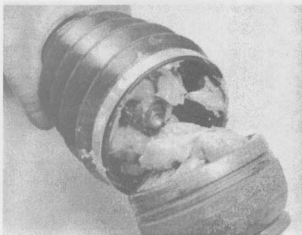
3.4т. Установите шарнир равных угловых скоростей на полуоси, выровняв шлицы; затем, пользуясь молотком с мягким бойком, насаживайте шарнир на полуось до тех пор, пока упорное кольцо не сядет в канавку
