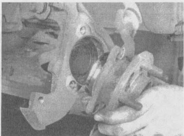
6.7. Стяните ступицу, подшипники и дисковый щиток с поворотного кулака
