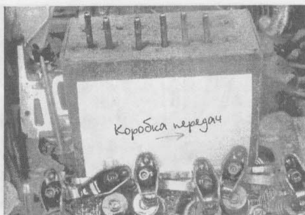
6.3. Для хранения штанг клапанов можно использовать картонную коробку с отверстиями; это обеспечит правильность их установки. Надпись на коробке указывает направление на коробку передач
