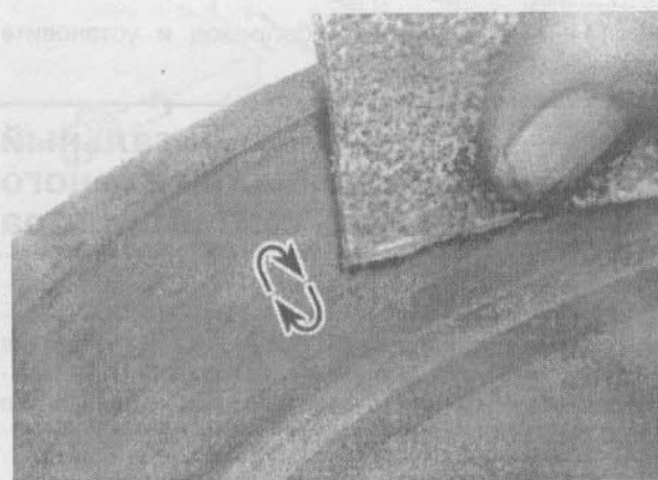
5.4ае. Удалите отполированные ("глазурованные") участки с поверхности тормозного барабана мелкозернистой шлифовальной шкуркой, обработав поверхность круговыми движениями
