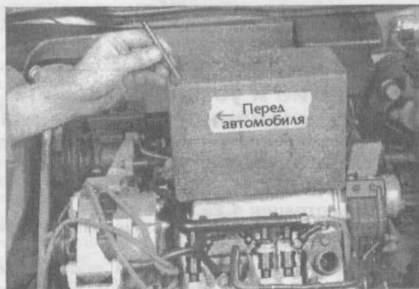
5.3. Если удаляется не одна штанга, храните их в картонной коробке с отверстиями, чтобы не перепутать при установке. Обратите внимание на надпись "Перед автомобиля"
