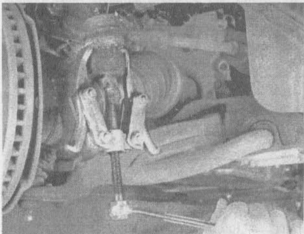
16.4. Удалив шплинт из корончатой гайки на пальце наконечника рулевой тяги и ослабив затяжку (не снимая) гайки, установите съёмник и отделите наконечник рулевой тяги от поворотного кулака
