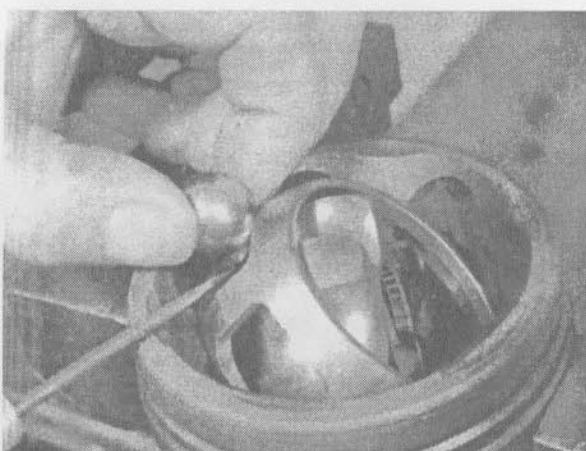
3.4г. Извлеките шарики из сепаратора по одному, пользуясь тупой отверткой или деревянным бруском
