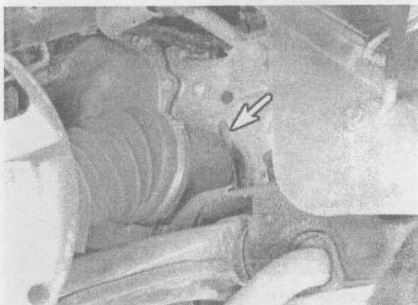
2.6. Пользуясь большой отверткой или монтировкой (указана стрелкой), вытолкните внутренний конец полуоси из коробки передач
