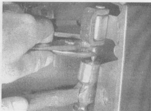
15.5б. ...плоскогубцами и выбейте пробойником фиксирующий штифт
