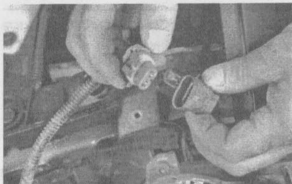
12.4. Надежно удерживая электрический разъем, выньте из него лампу
